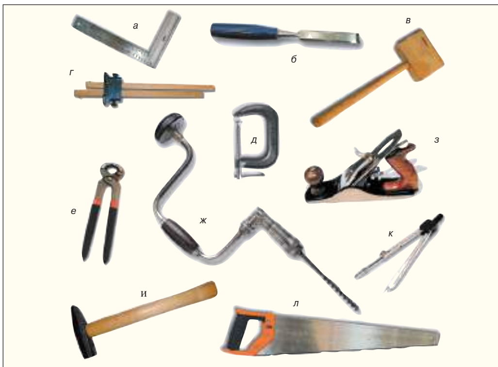
Рис. 1.11. Инструменты, используемые при обработке древесины: а — угольник, б — стамеска, в — киянка (деревянный молоток), г — рейсмус (разметочный инструмент для проведения параллельных линий), д — струбцина, е — клещи, ж — коловорот, з — рубанок, и — молоток, к — циркуль, л — ножовка
