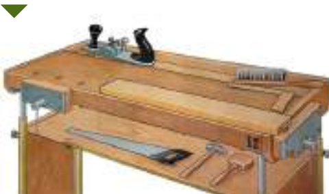
Рис. 1.9. Размещение инструментов на столярном верстаке
