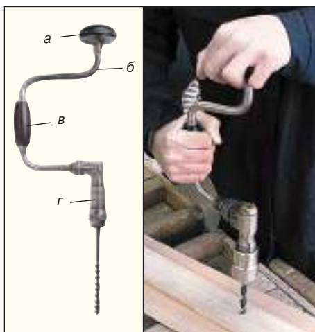
Рис. 1.25. Коловорот и операция сверления отверстия: а — деревянный грибок, б — скоба (стальное колено), в — ручка, г — патрон; операция сверления
