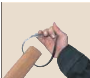
Рис.1.19. Измерение внешних размеров круглой детали
