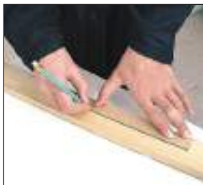
Рис. 1.16. Проведение линии с помощью линейки
